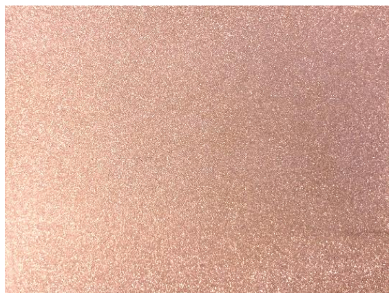
Рисунок 2. Внешний вид металлизированной керамической подложки из AlN с толщиной медного покрытия 100 мкм.
