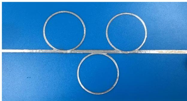
**Рисунок 3.** Макет исследуемого полосно-пропускающего фильтра на кольцах.
