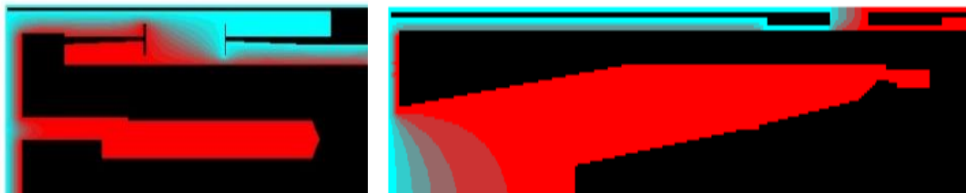
Рисунок 4. Распределение электрического поля в коллекторе КИУ-271 (слева) и КИУ-273 (справа)
