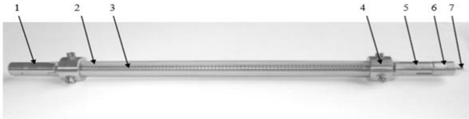
Рисунок 1. Сборка спирали с опорными керамическими стержнями для твердофазного соединения, где 1-неподвижная втулка, 2- молибденовые вкладыши, 3-спираль, 4 кольцо, 5- подвижная втулка, 6-гайка, 7-стержень
