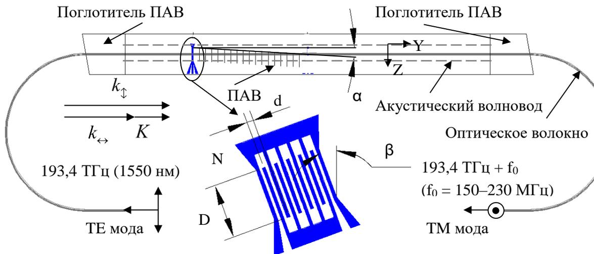
**Рисунок 1.** Конфигурации образца преобразователя ТЕ-ТМ мод и ВШП ( $D = 1,7$  мм или 100 мкм – длина перекрытия электродов,  $d = 10$  мкм – расстояние между центрами соседних электродов,  $N = 17$  или 40 – число электродов,  $\beta = 0-5^\circ$  – компенсационный угол между электродами и осью  $Z$ ,  $\alpha = 4.2^\circ$  – угол между направлением распространения ПАВ и нормалью к её фазовому фронту [7] для  $\beta = 0^\circ$ ).
