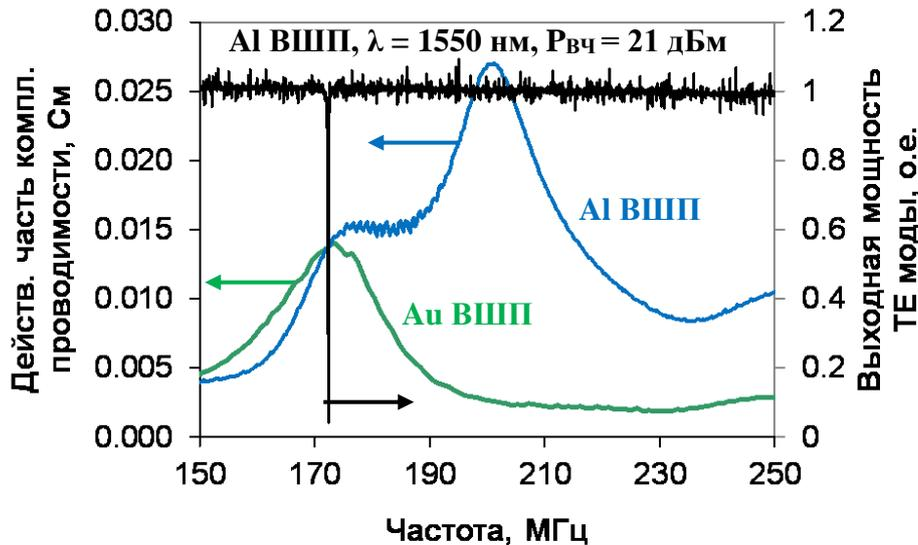
**Рисунок 2.** Частотные зависимости действительной части комплексной проводимости для золотых и алюминиевых ВШП с 17 электродами и длиной перекрытия 1,7 мм (левая шкала), частотная зависимость акустооптического преобразования поляризации внутри оптического волновода (правая шкала).
