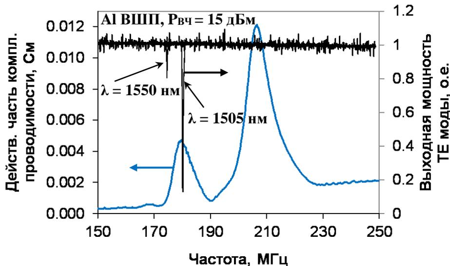
**Рисунок 3.** Частотная зависимость действительной части комплексной проводимости для алюминиевого ВШП с 40 электродами с длиной перекрытия 100  $\mu\text{м}$  (левая шкала), частотные зависимости акустооптического преобразования поляризации при длинах волн 1505 нм и 1550 нм внутри оптического волновода (правая шкала).
