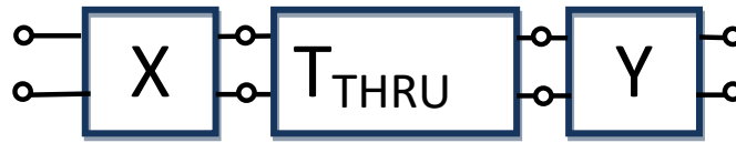
Рисунок 3. Матричное представление короткой коаксиальной линии.
