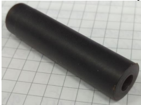
Рисунок 2. Изготовленная деталь из исследуемого твердого диэлектрика
