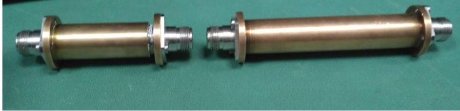
Рисунок 1. Измерительные коаксиальные оснастки со смонтированными разъемами N-типа.
