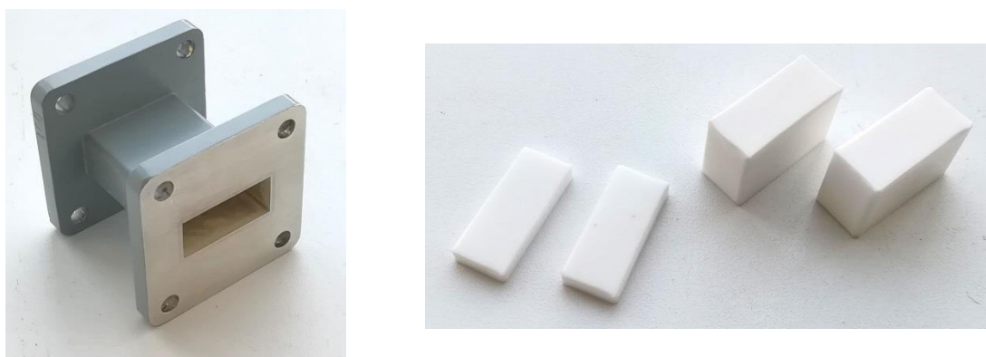
Рисунок 3. Измерительная камера и образцы материалов для измерений в диапазоне 8,5 – 12 ГГц
