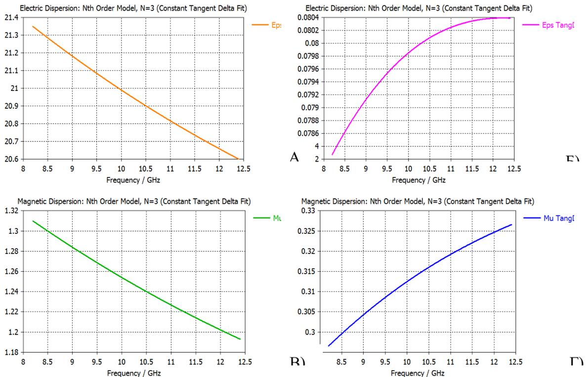
**Рисунок 6.** Электромагнитные параметры керамики ПКМ-35Ж: А) диэлектрическая проницаемость; Б) тангенс электрических потерь; В) магнитная проницаемость; Г) тангенс магнитных потерь.
