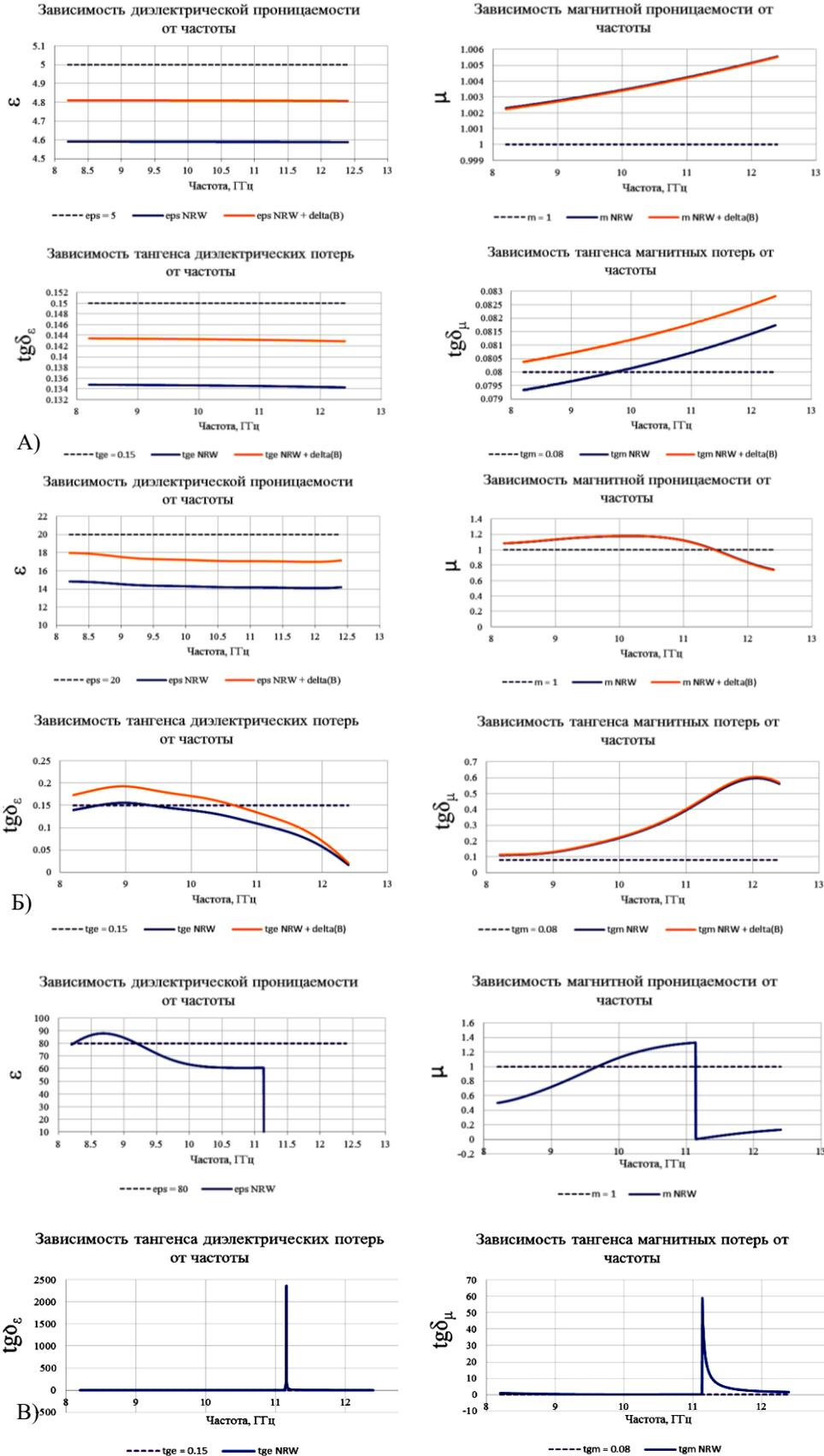
**Рисунок 2.** Диэлектрические и магнитные характеристики, рассчитанные с помощью скорректированного и нескорректированного алгоритма NRW для трех эталонных образцов материала с длиной 3 мм, зазором 161 мкм,  $\mu = 1$ ,  $\text{tg} \delta_\epsilon = 0.15$ ,  $\text{tg} \delta_\mu = 0.08$  и  $\epsilon = 5$  (А),  $\epsilon = 20$  (Б),  $\epsilon = 80$  (В).
