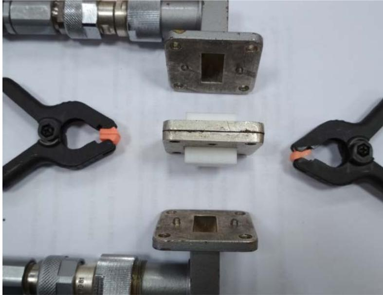
Рис. 1. Измерительная ячейка с коаксиально-волноводными переходами
