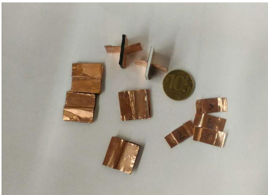
Рис.2. Образцы плоскопараллельных конденсаторов на основе пластиков ABS и PLA.
