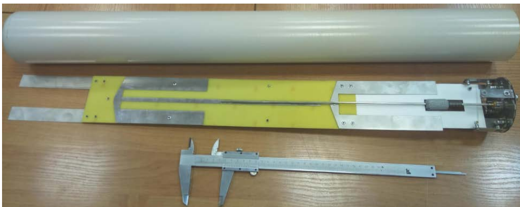
Рис. 5. Макет двухэлементной коллинеарной решетки
