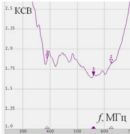
Рис. 6. Экспериментальная зависимость КСВ от частоты
