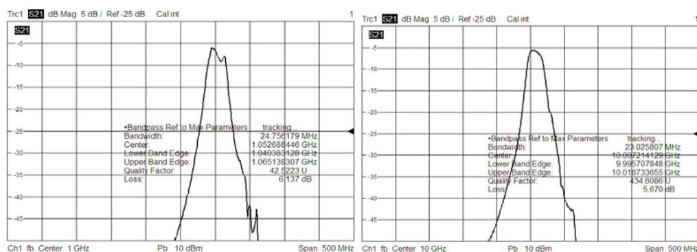
Рис. 2. АЧХ трехзвенного фильтра повышенной мощности в диапазоне частот от 1 до 10 ГГц
