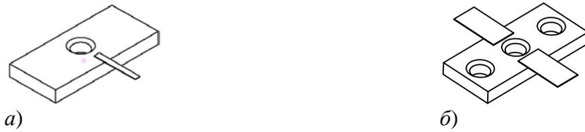
Рис. 5. Конструкция короткозамкнутой нагрузки для: *a* - нагрузок мощностью 10 и 20 Вт; *б* - проходных резисторов
