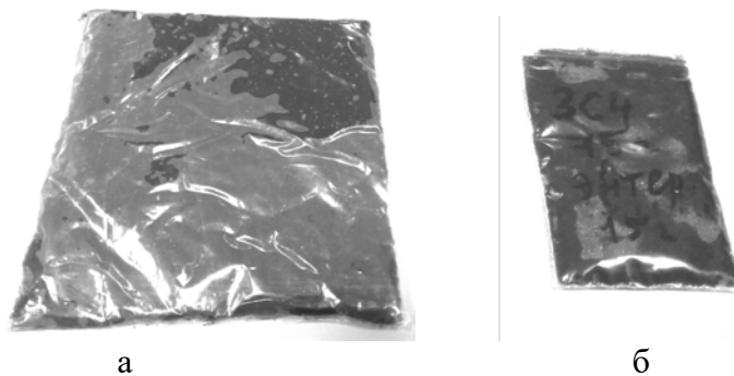
Рис. 1. Внешний вид исследуемых образцов: а – для рупорной измерительной ячейки, б – для копланарной измерительной ячейки.
