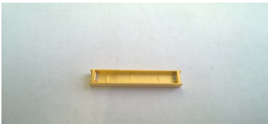
Рис.3 Металлокерамический корпус транзисторного усилителя мощности.
