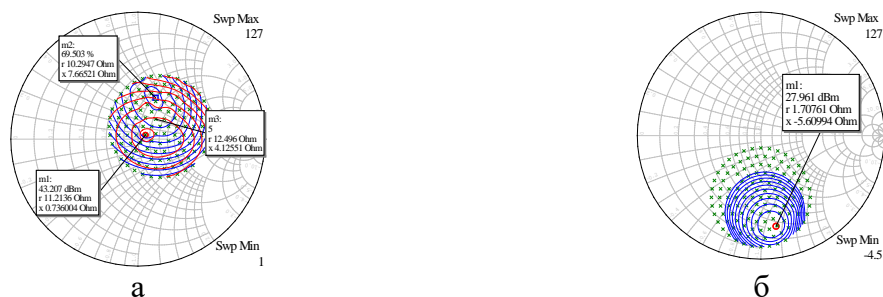
Рис. 2. а) - результат определения оптимального импеданса нагрузки Z_L модели транзистора ПП9137А по методу Load Pull ( Z_0 = 10 \text{ Ом} , f=4 \text{ ГГц} ), б) - результат определения оптимального импеданса источника Z_S модели транзистора ПП9137А по методу Source Pull ( Z_0 = 5 \text{ Ом} , f=4 \text{ ГГц} )
