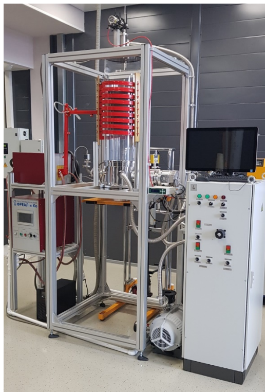
Рис. 1. Установка роста монокристаллов 4H-SiC.
