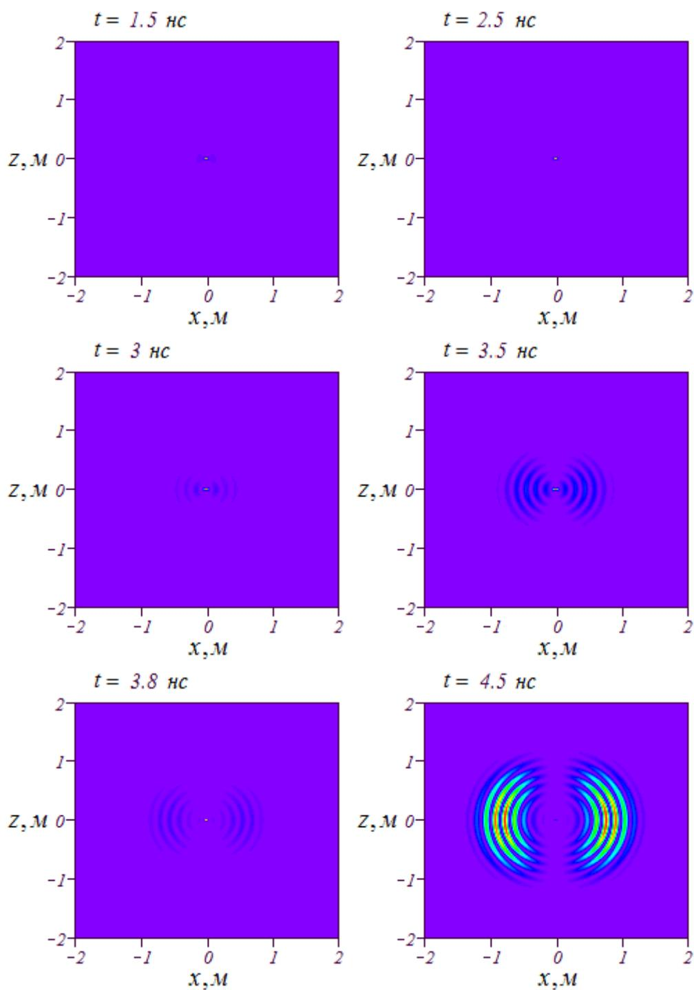
Рис. 2. Плотность энергии диполя, возбужденного гауссовским импульсом, в зависимости от координат в различные моменты времени.
