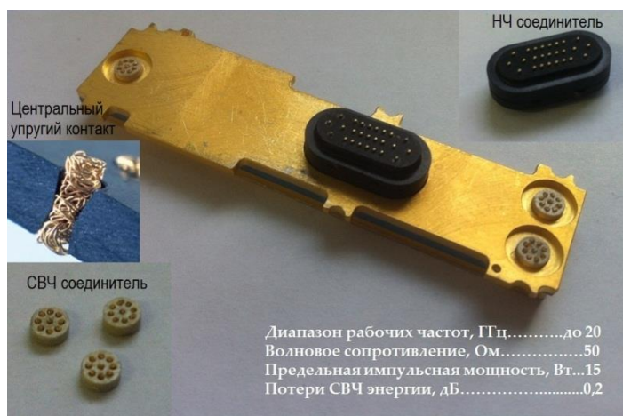
Рис. 4. СВЧ и НЧ соединители, разработанные в ОАО, «Карачевский завод «Электродеталь»
