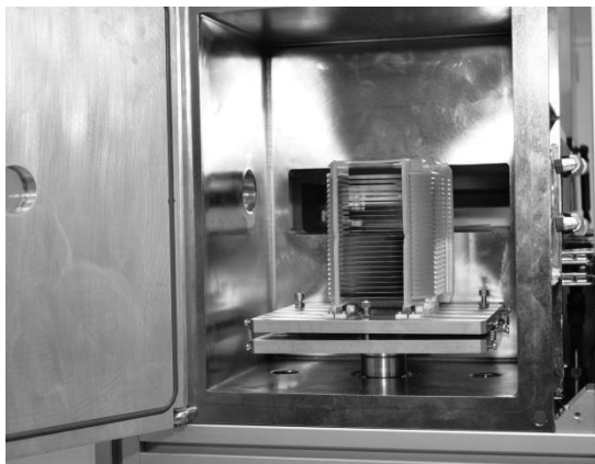
Рис.2. Шлюзовая камера (а) и распределительный модуль (б) установки «Плазма ТМ 8».
