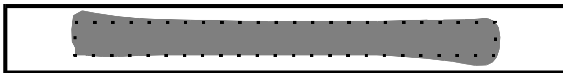
Рис. 4. Фокусировка прямоугольного пучка: изменение сечения ленточного пучка при B=0.5 Тл на выходе ЗС. Пунктир – форма пучка на входе
