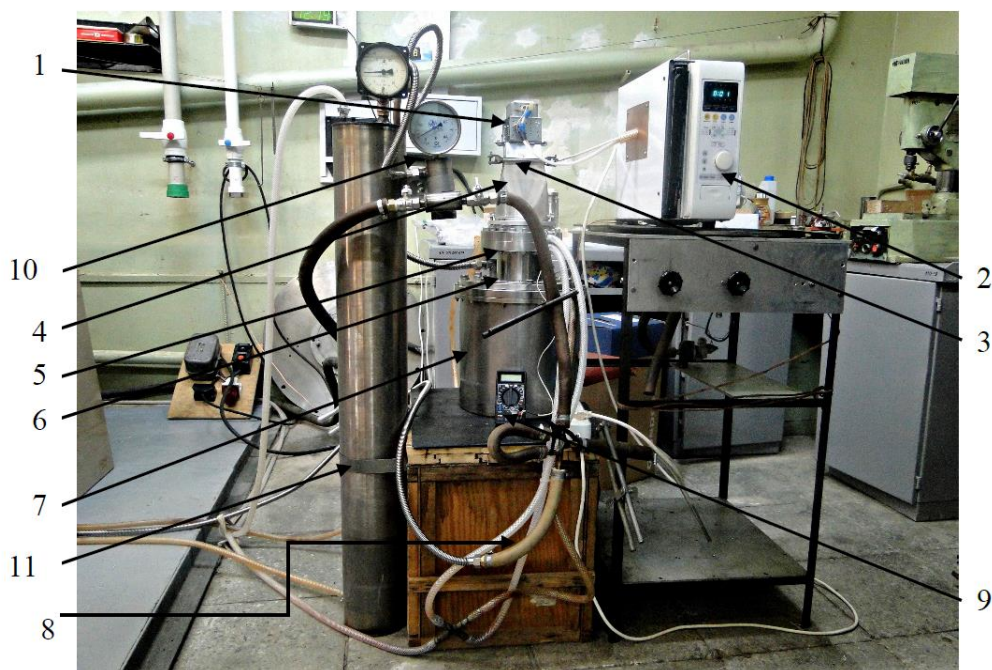
Рис. 1 Фотография установки для исследования процесса пиролиза торфа при нагреве СВЧ-излучением: 1 - промышленный магнетрон; 2 - система сетевого питания; 3 - система воздушного охлаждения; 4 - согласующие волноводные элементы; 5 - барьерное окно; 6 - волновод связи; 7 – рабочая камера реактора; 8 - система водного охлаждения; 9 - термопара; 10 - манометр; 11 – теплообменник
