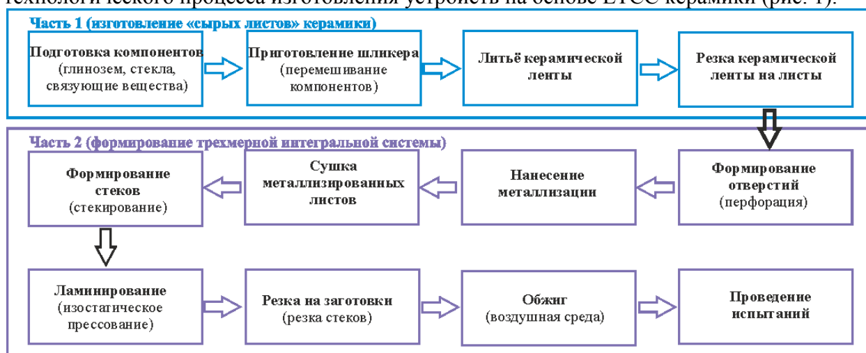
Рис. 1 .Технология изготовления интегральных структур на основе ЛТСС керамики.
