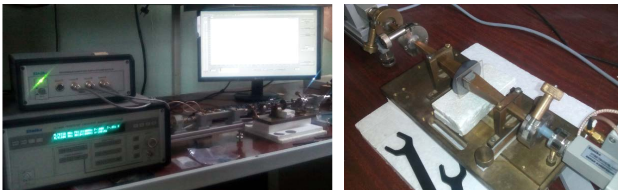
Рис. 2. Стенд для измерения H_a и \Delta H магнитно-одноосных ферритов (слева) и ферритовый образец помещенный в измерительную оправку (справа).
