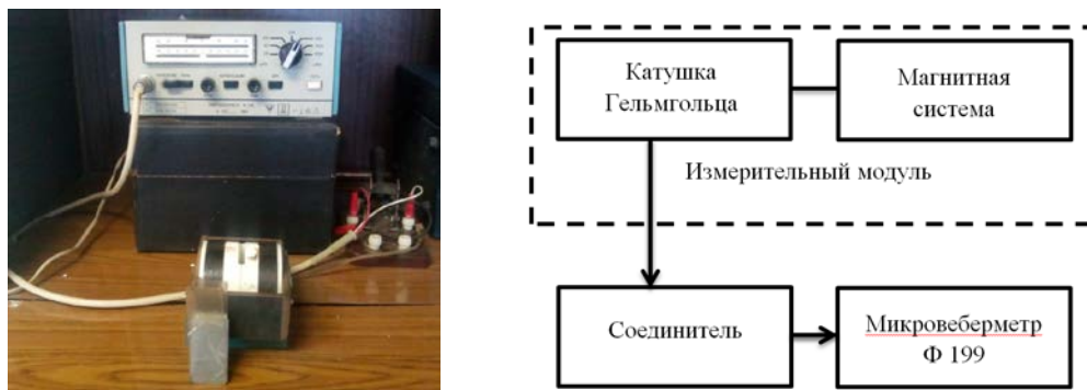
Рис. 3. Внешний вид (слева) и блок схема (справа) установки для измерения M_s .
