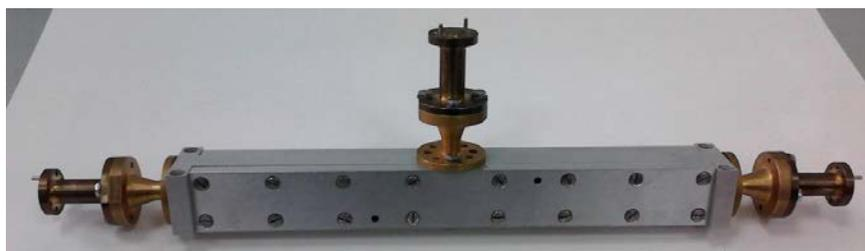
Рис. 2. Фотография изготовленного разделителя потоков излучения с разной поляризацией.
