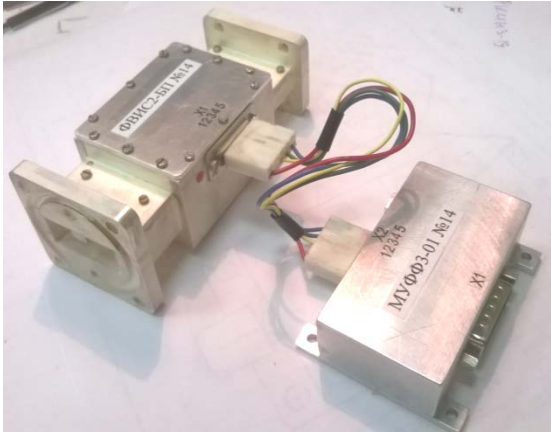
Рис. 5. ППФ ФВИС2-БП с драйвером типа 2 (слева - ППФ, справа - драйвер)
