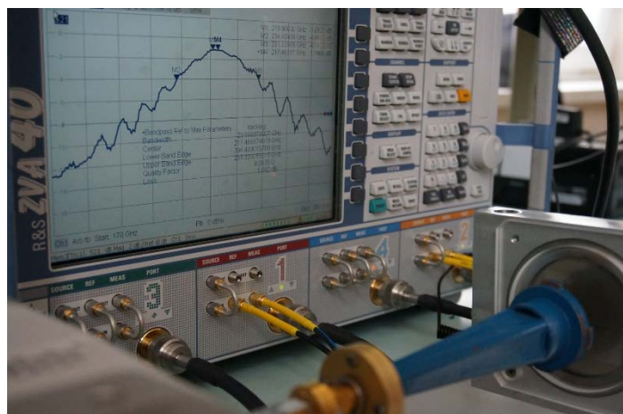
Рис. 3. Измерение полосового фильтра в открытом пространстве.
