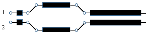
Рис. 1 - Структура ФК на трёхступенчатой связанной ЛП класса II [1].
