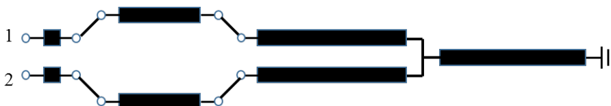
Рис. 2 - Структура ФК на модифицированной трёхступенчатой связанной ЛП класса П со шлейфом.
