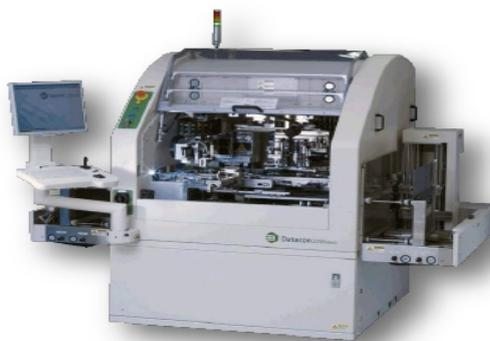
Фото 1. Установка поверхностного монтажа Datacon 2200 Evo.
