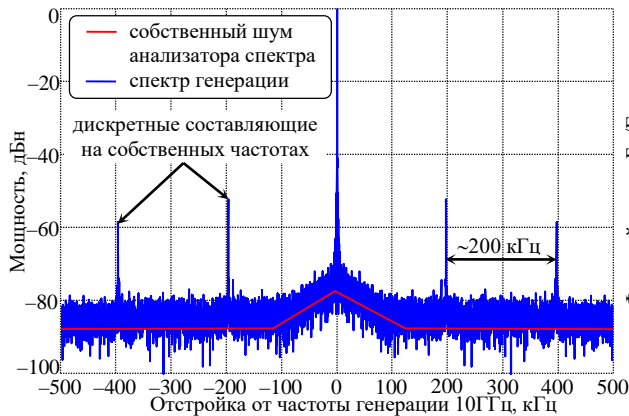
Рис. 4. Спектр ОЭГ на линиях задержки с полностью оптическим усилением.
