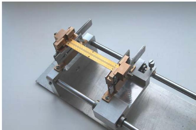
Рис. 3. Универсальное контактное устройство с проходной полосковой мерой волнового сопротивления
