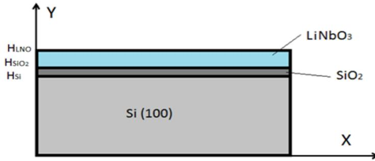
Рис. 1. Слоистая структура YZ-LiNbO<sub>3</sub>/SiO<sub>2</sub>/Si(100).
