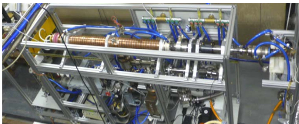
Рис. 9. Ускорительная секция излучателя электронов.
