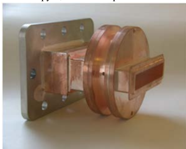
Рис. 7. Асимметричное баночное окно, встроенное в волноводный переход. Беспаразитная полоса пропускания окна составляет около 50% по уровню КСВН \leq 1,2 .
