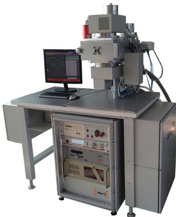
Рис. 1. Установка глубокого анизотропного травления МВУ ТМ Плазма 06.
