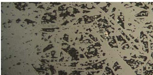
Рисунок 2 – Поверхность GaN после отжига при температуре 1300 °С.
