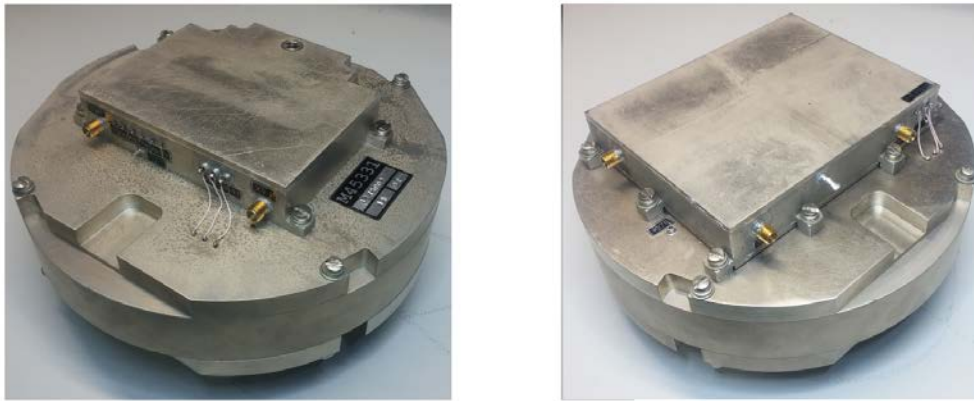
Рис. 1. Внешний вид разработанного приемопередающего СВЧ модуля с импульсной выходной мощностью более 1 Вт.
