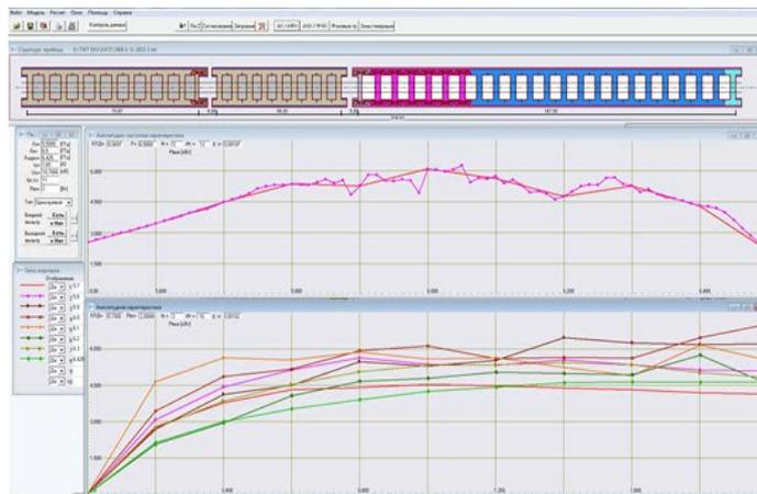
Рис.4 Расчет амплитудных  $R_{вых}=f(R_{вх})$  и амплитудно-частотных характеристик ЛБВ с модернизированной ЗС при напряжении ЗС 18,7 кВ, токе катода 1,65 А.
