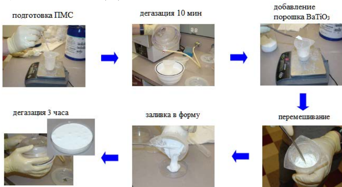
Рисунок 1. Процесс изготовления образцов композиционного материала.
