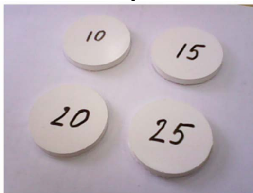
Рисунок 2. Образцы композиционного материала с различным процентным содержанием порошка BaTiO 3 .
