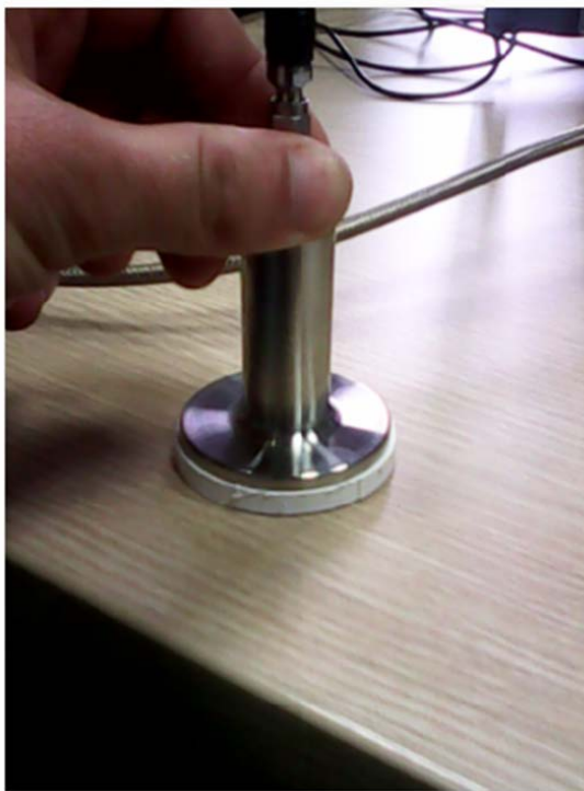
Рисунок 7. Измерение свойств композитного материала ПАК SPEAG.
