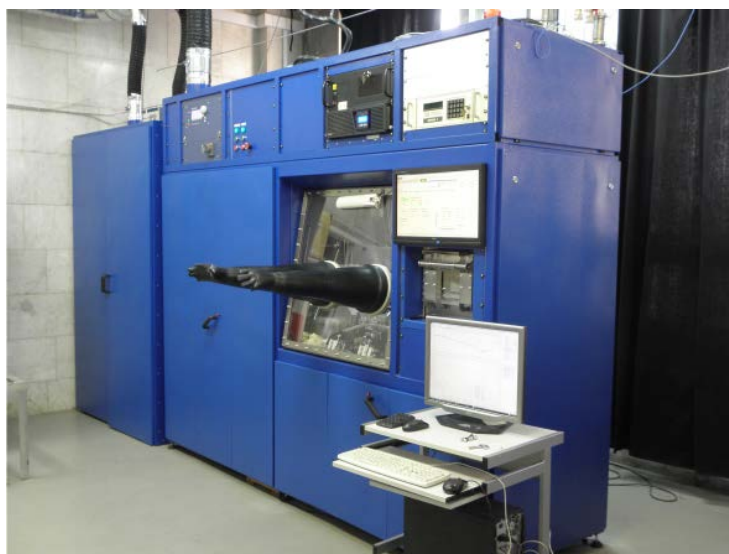
Рис. 1. Установка МОС-гидридной эпитаксии опытного производства гетероструктур на основе нитрида галлия.
