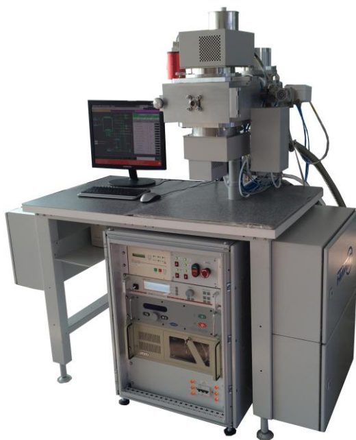
Рисунок 1. Установка глубокого анизотропного травления МВУ ТМ Плазма 06
