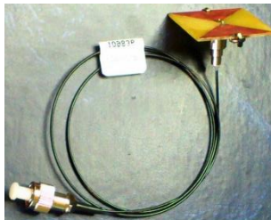
Рисунок 3. Передающая фотонная антенна на основе мощного фотодиода СВЧ-диапазона
