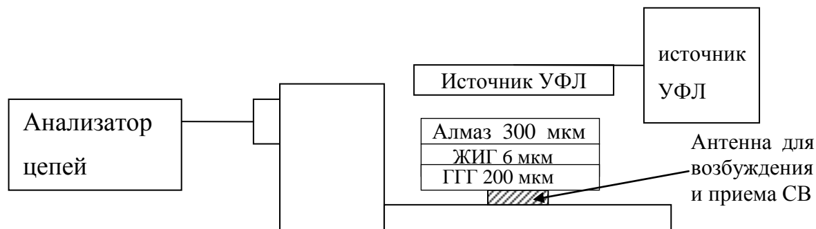
Рисунок 3. Блок-схема датчика УФЛ на основе структуры алмаз/ЖИГ
