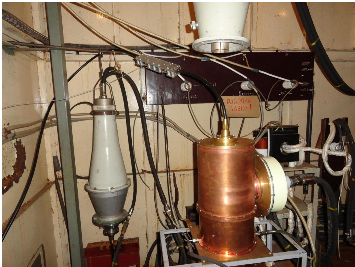
Рисунок 1. Автогенератор с нагрузкой в испытательном стенде
