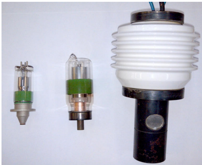
Рисунок 7. Рентгеновские трубки для досмотровой аппаратуры, основанной на регистрации обратно рассеянного рентгеновского излучения.
