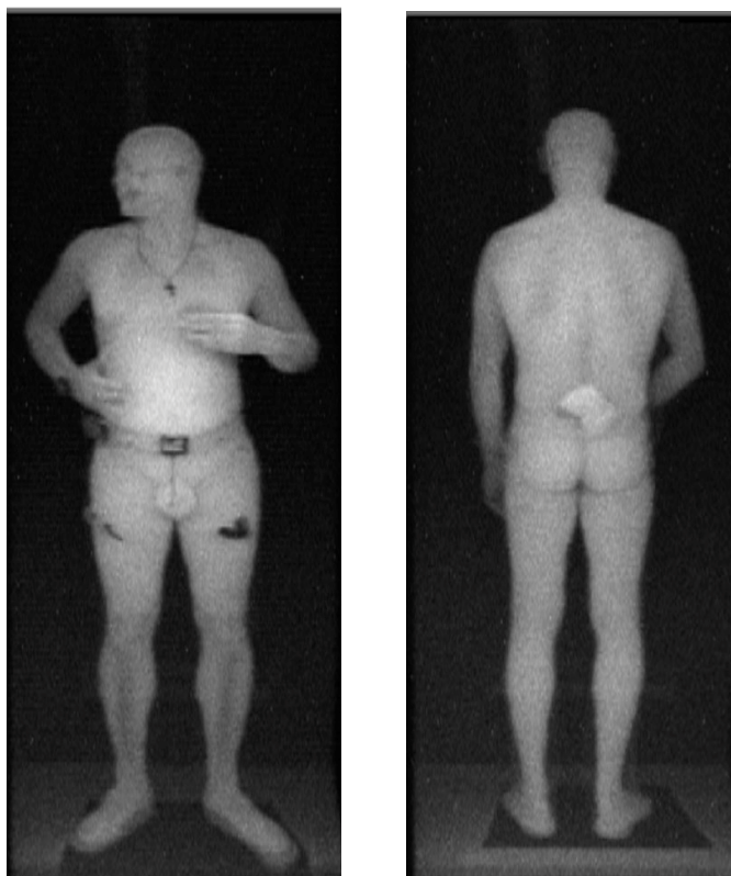
Рисунок 4. Изображение, полученное с помощью рентгеновского комплекса «Рубеж-ПЧ»
