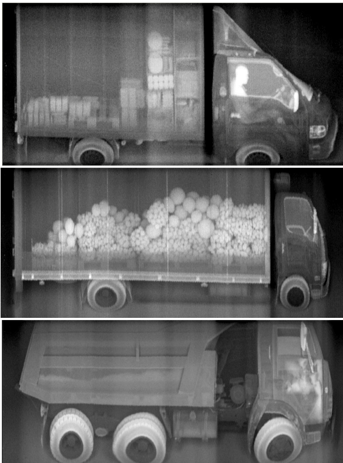
Рисунок 6. Изображения, полученные с помощью рентгеновского комплекса «МРК-1».
