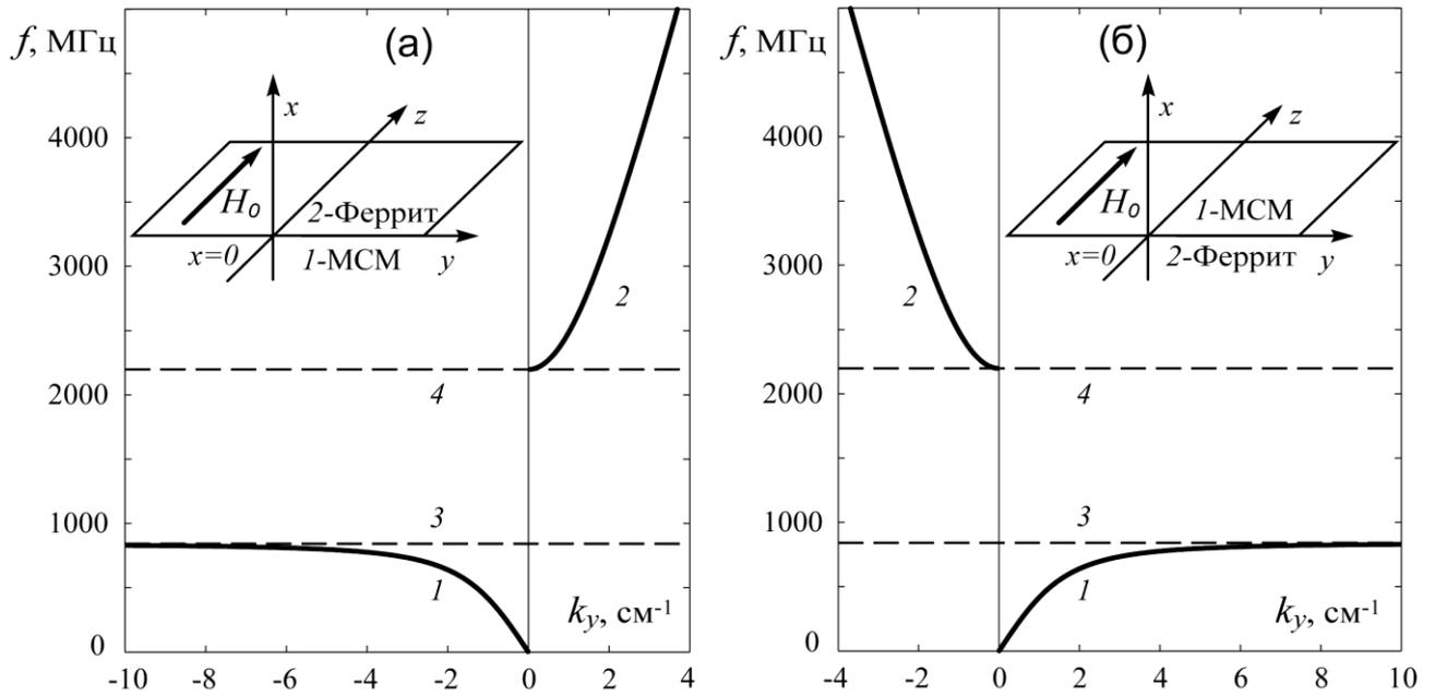
Рис. 3. Дисперсионные зависимости  $f(k_y)$  поверхностных электромагнитных волн в ферритовом полупространстве, граничащем с МСМ. (а) и (б) – для структур  $\Phi$ -МСМ и МСМ- $\Phi$  (соответствующие геометрии даны на вставках). Кривые 1 и 2 соответствуют спиновой и электромагнитной ветвям. Показаны прямые 3 и 4 –  $f_H = \text{const}$  и  $f_0 = \text{const}$ .
