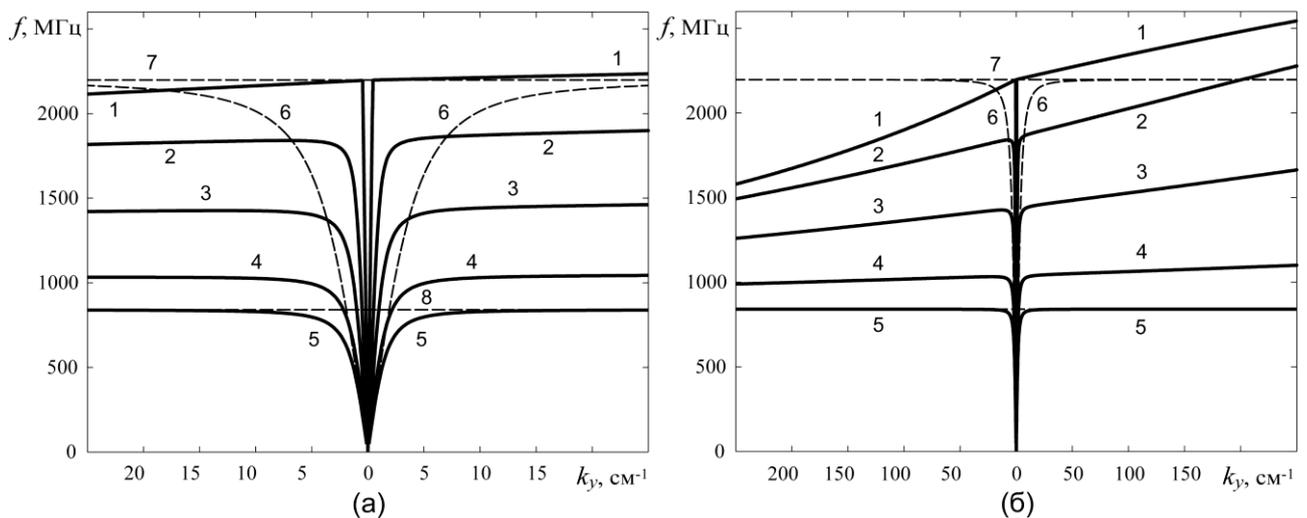
Рис. 2. Дисперсионные зависимости спиновых волн в ферритовой пленке, нижняя поверхность которой граничит с МСМ, а расстояние  $d$  между верхней поверхностью пленки и вторым слоем МСМ меняется от  $\infty$  до 0 (а – вид в области малых волновых чисел, б – общий вид). Кривые 1 – 5 соответствуют значениям  $d$ :  $\infty$ , 20, 5, 1 мкм и 0.
