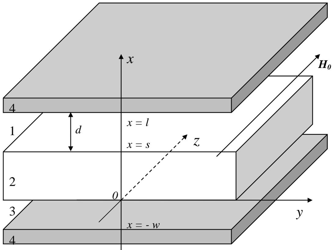
Рис.1. Геометрия задачи: 1 – слой диэлектрика толщиной  $d$ , 2 – ферритовая пластина толщиной  $s$ , 3 – слой диэлектрика толщиной  $w$ , 4 – слои, обеспечивающие граничные условия типа магнитной стенки или идеально проводящей плоскости.
