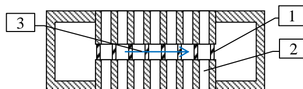
Рис. 1 Резонатор многолучевого клистронов с индуктивными вставками. 1 – индуктивные вставки, 2 – каналы, 3 – направление распространения волны
