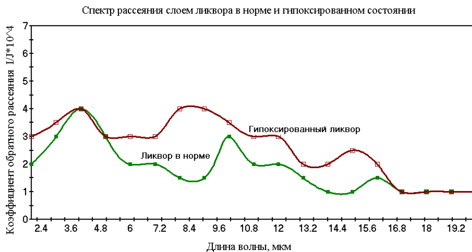
Рис.2. Спектр ИК обратного рассеяния слоем ликвора в норме и гипоксированном состоянии. Слой толщиной 2 мм заключён между пластинами (толщиной 0,5 мм) сапфира и кремния, имеющими микро- и нанонеоднородные поверхности. Температура 15 °С.
