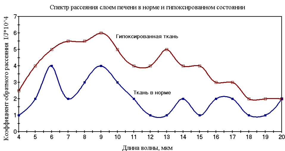
Рис.3. Спектр ИК обратного рассеяния слоем печени в норме и гипоксированном состоянии. Слой толщиной 2 мм заключён между пластинами (толщиной 0,5 мм) сапфира и кремния, имеющими микро- и нанонеоднородные поверхности. Температура 15 °С.
