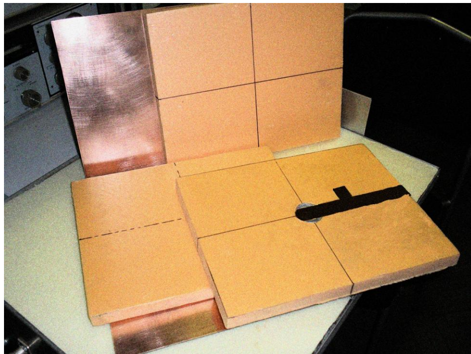
Рисунок 7. Реализация НПЛ, резонатора и емкости в макете ОИС.
